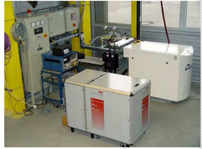
Stirling Whispergen Elektrische Leistung 1,2 kW Thermische Leistung 8 kW
